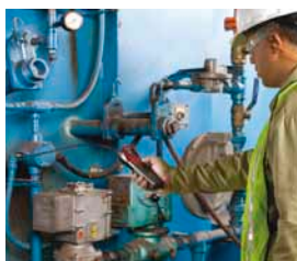
Detektor CD-100 se používá pro detekci plynu při údržbě zařízení a budov
